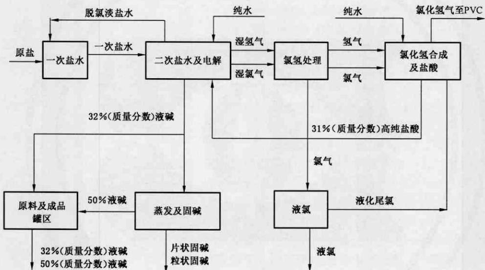
图 C.1 烧碱产品工艺流程图
